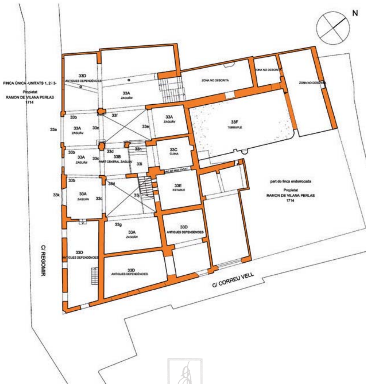
57. Regomir, núm. 11-19. Unitats 2 i 3. Restitució arquitectònica l'any 1714. P. B.
