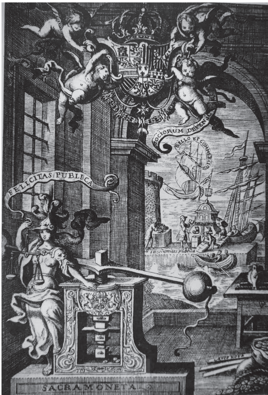
18. Gravat de fra Matías de Irala (1680-1753) que mostra una pressa de balancí i una màquina d'acordonar moneda, segle XVII.
